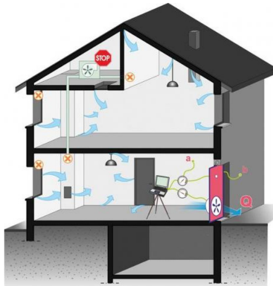
Figura 3. Esquema de funcionamiento de un test de estanqueidad en modo despresurización (extracción de aire de la vivienda). Fuente: CEREMA, Romuald Jobert.
