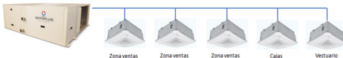
Figura 4. Sistema VWF con 5 interiores tipo cassette.
