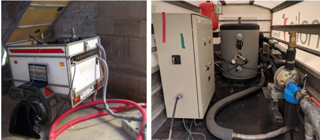
Figura 1. Equipo de Respuesta Térmica diseñado por Tecnalia Research & Innovation.
