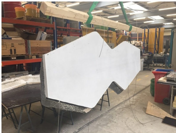
Figura 6. Muestra del panel de fachada preparada para el ensayo del rendimiento climático.
