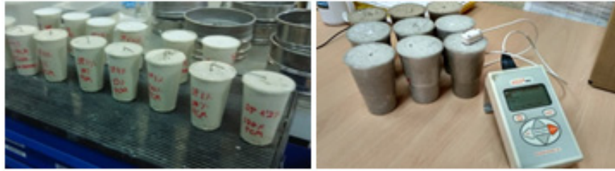
Figura 2. Ejemplos de muestras de mortero analizadas para el cálculo de la conductividad térmica.
