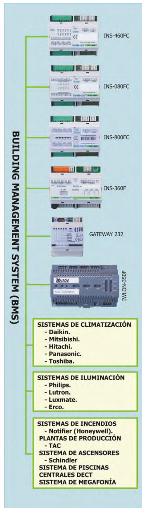
Figura 5. Esquema del subsistema BMS aplicado por la empresa ISDE.
