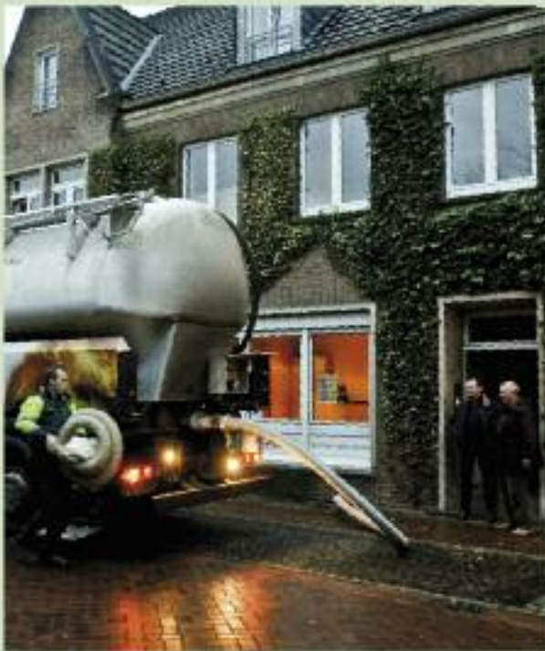
Suministro de pelets con el vehículo-cisterna
