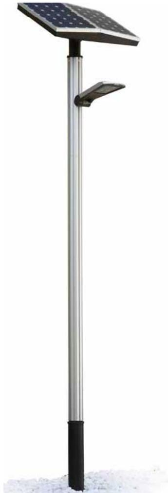
1. Dos módulos fotovoltaicos con sensor lumínico encargados de generar una potencia de 120Wp, con una superficie total de 0,92 m<sup>2</sup>. La luminaria se autogestiona gracias a su sensor lumínico que controla el flujo de la luminaria en función de la aportación de luz diurna, así como de su electrónica con ciclos nocturnos programados.
