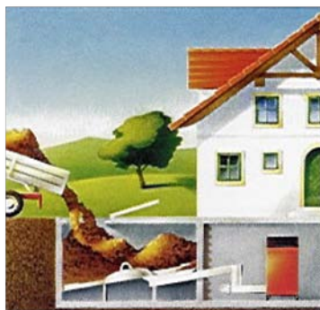
Ilustración 39. Descarga de las astillas en un silo situado bajo el nivel del suelo. Fuente: CECU.
