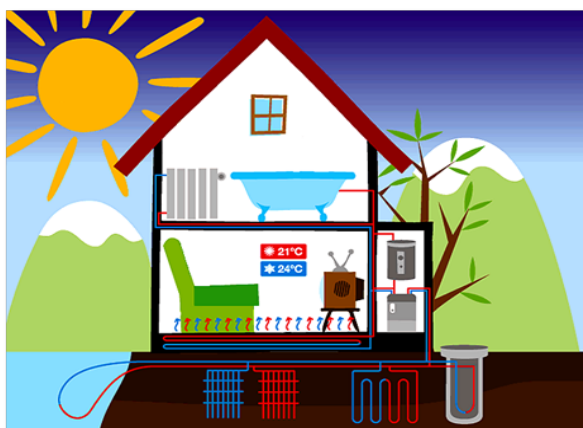
Ilustración 52. Bomba de calor geotérmica en una vivienda unifamiliar.
