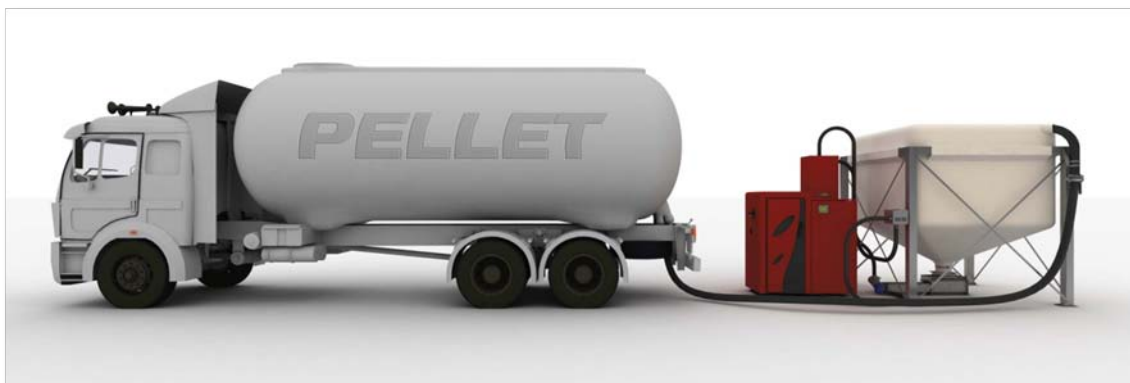
Ilustración 46. Suministro de pellet mediante camión cisterna con bomba neumática. Fuente: Ecosar.
