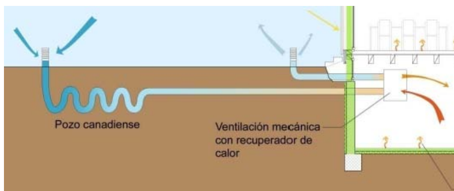
Ilustración 82. Sistema de ventilación mecánica. Vivienda unifamiliar de Lleida.
