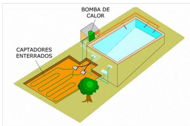
Ilustración 58. Esquema de climatización de una piscina con apoyo geotérmico. Sistema de captación horizontal. Fuente:www.ingelco.es.
