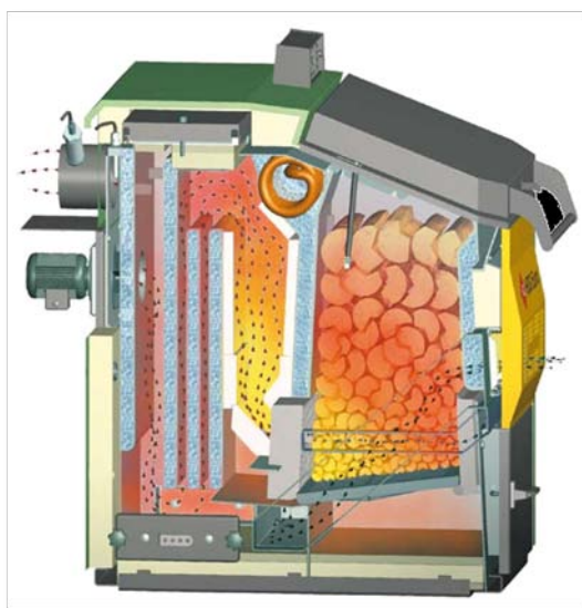
Ilustración 38. Esquema de funcionamiento de una caldera de leña. Fuente: HDG.
