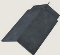
CABALLETE SK SK RIDGE FAÎTIÈRE SK 520 x 312 x 107,5 mm. 4,10 Kg. 2,22 ud/ml
