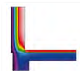
Termografía de la fachada con aislamiento por el exterior tipo SATE.
