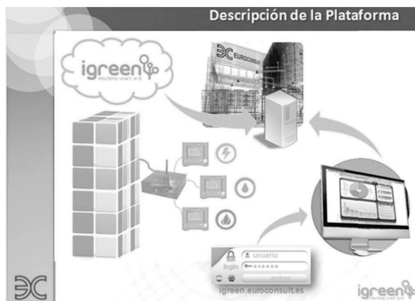
Figura 1. Esquema de funcionamiento del Sistema de Gestión Energética iGreen.
