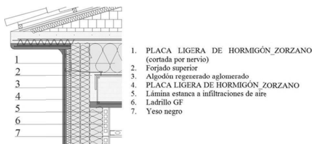
Figura 6. Solución constructiva fachada-forjado superior.
