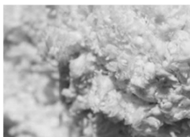
Figura 3. Lana Mineral virgen, sin ligante, para insuflado de cámaras de aire.
