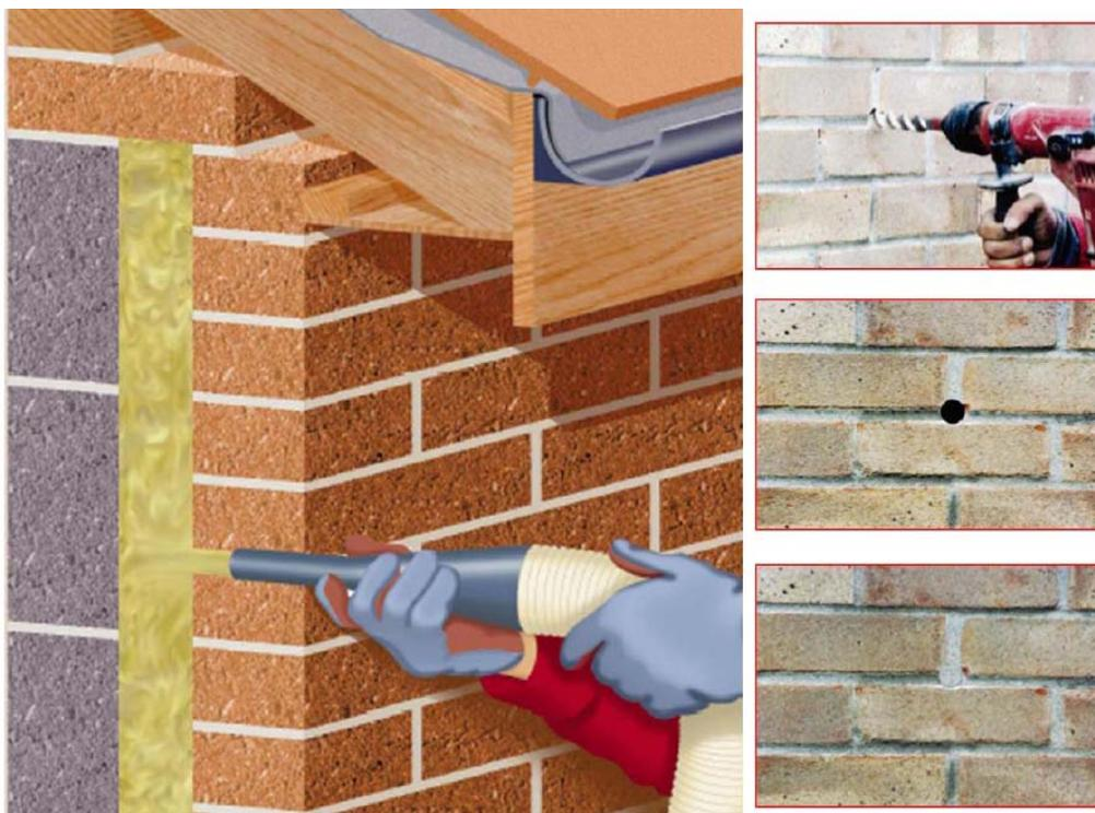
Figura 55.- Relleno de cámara de fachada
