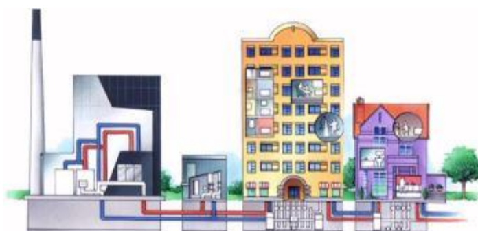
Ilustración 16. Ejemplo esquemático de una red de distribución de calor y frío
