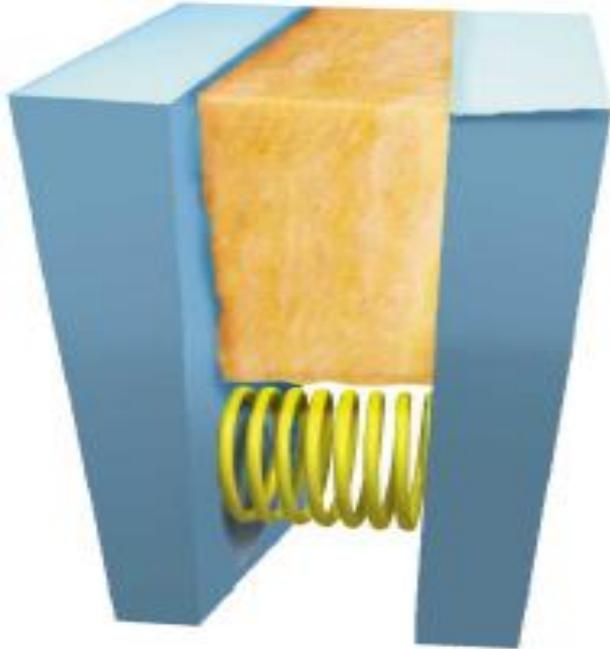
Los sistemas PYL funcionan acústicamente bajo el principio MASA-MUELLE-MASA.
