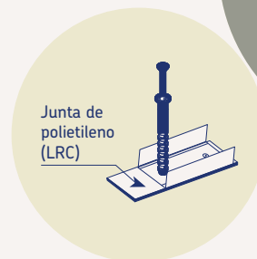
Sistema de fijación recomendado Taco de golpe (Ref. 359910) Broca hormigón SAS Plus 54
