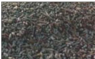
La viabilidad técnica en cuanto a la obtención de densificados de calidad a partir de residuos forestales ha sido puesta de manifiesto en todas las pruebas realizadas con las diferentes fracciones granulométricas de las muestras utilizadas, obteniéndose productos de características cualitativas perfectamente
