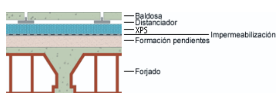
Figura 7. Detalles constructivos para azoteas invertidas no transitables y transitables.
