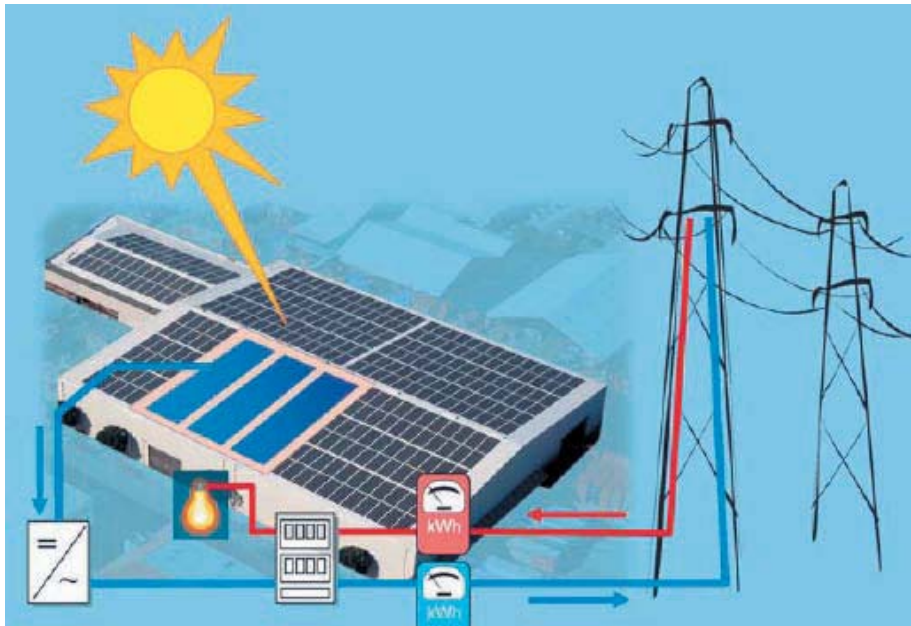
Figura 10. Contador y sistemas de monitorización.
