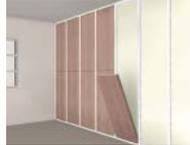
3 – Colocación de Lana Mineral Natural Ultracoustic P insertado en la estructura.
