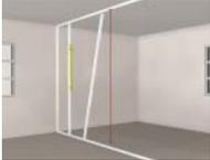
1 – Replanteo, colocación y fijación mecánica de estructura de entramado autoportante, a base de canales horizontales inferior y superior, y montantes verticales separados 40 o 60 cm entre sí.
