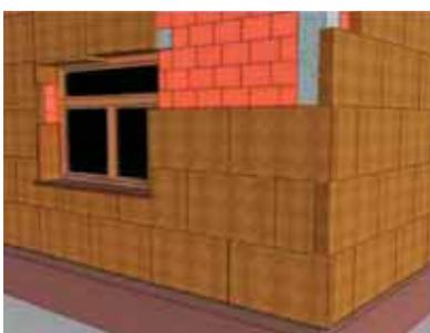
Fase 2 - Los paneles de Lana Mineral deben colocarse en sentido ascendente (de abajo hacia arriba), con juntas verticales discontinuas (colocación a rompejuntas).
