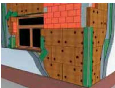
Fase 5 - Por último se procede con la aplicación del recubrimiento base, la armadura de refuerzo, la imprimación y el revestimiento final.
