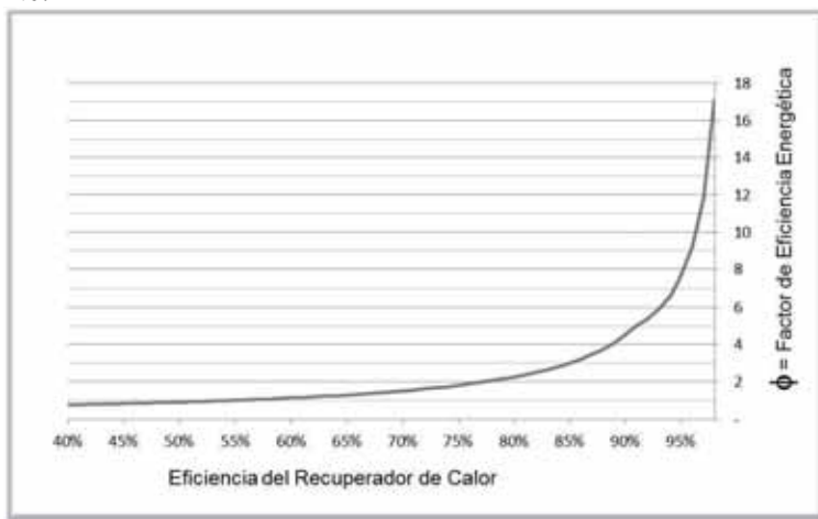
Figura 6. Gráfico del Factor ( \phi ) de Eficiencia Energética de distintos recuperadores de eficiencias entre 40% y 98% con respecto a un recuperador estándar de eficiencia 55% ( \phi = 1 ).
