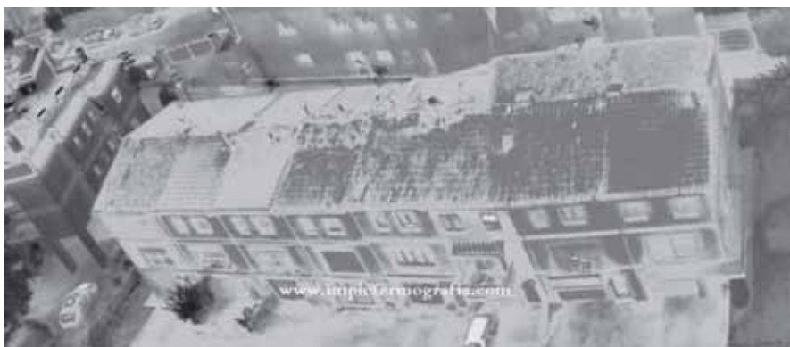
Figura 1. Termografía aérea donde se aprecian las diferentes temperaturas superficiales de la envolvente de un grupo de edificios. La diferencia de temperaturas viene dada por numerosas variables, como las propiedades de los materiales, factores ambientales externos como la radiación solar, viento, temperatura ambiente, y factores internos como fuentes de calor, etc.
