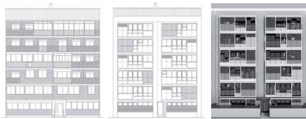
Figura 3. Alzados de la fachada actual y la reformada. Imagen 3D de la intervención.
