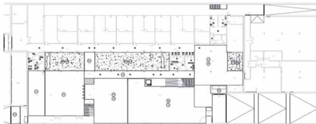
Figura 3. Instalación de detectores de presencia en el interior del edificio
