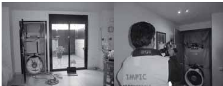
Figura 6. Realización de prueba Blower Door en vivienda.
