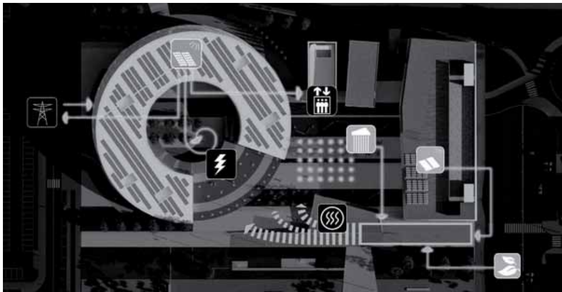
Figura 4. Gráfico indicando las fuentes de energía y su posición en Orona IDEO. Se indica en azul la energía eléctrica y en naranja energía térmica distribuida a través del District Heating-Cooling.
