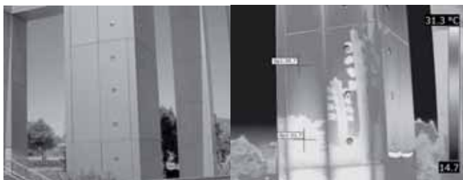
Figura 2. Termografía de cerramiento de aluminio con radiación reflejada.
