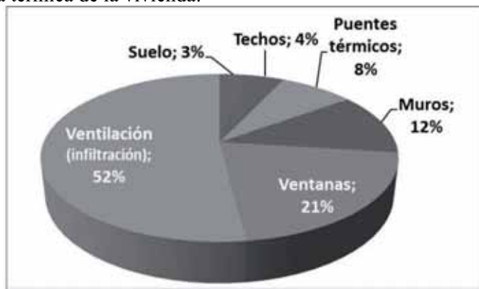
Figura 1. Repartición de la pérdida térmica de una vivienda, considerando los valores de ventilación y aislamientos exigidos actualmente por el CTE. Fuente: Ortiz, Leon & Feilden Clegg Bradley.
