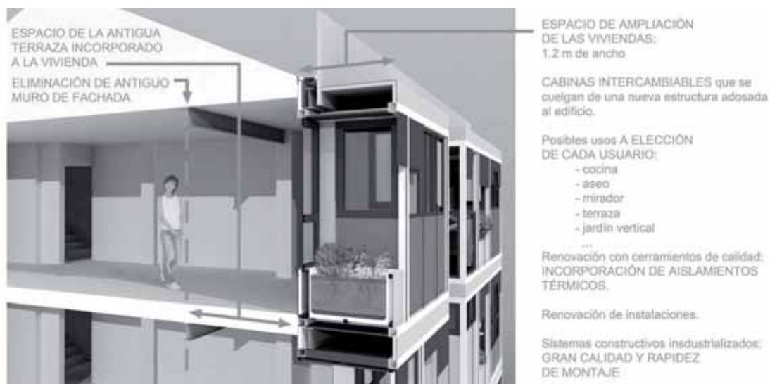
Figura 2. Sistema de cerramiento propuesto con la intervención
