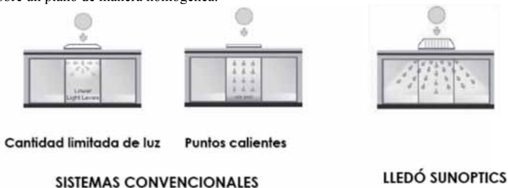
Figura 4. Sistemas de iluminación convencional frente a microprismáticos
