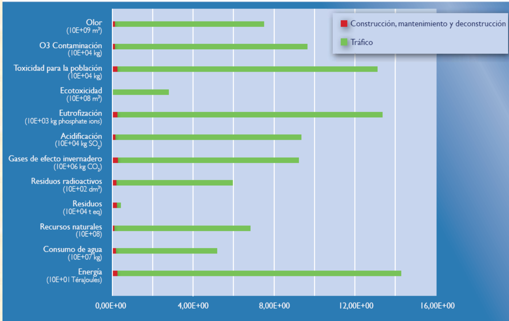
Figura 2: Impacto de un pavimento de hormigón en masa con juntas durante el ciclo de vida (incluido el tráfico) según varios indicadores medioambientales.
