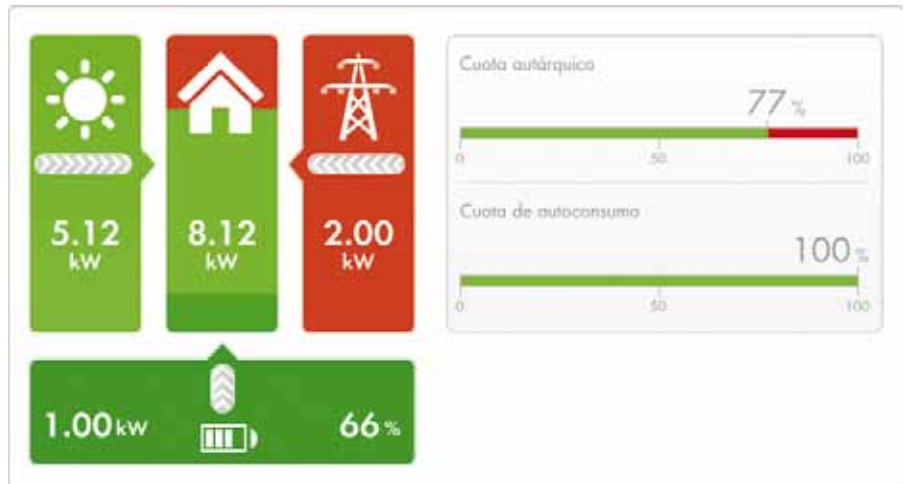
El resumen muestra los datos de potencia actuales de producción, inyección a red y consumo de la red.
