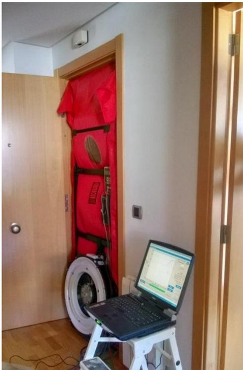
Fig. 6: Colocación del equipo Blower Door para el ensayo de una vivienda
