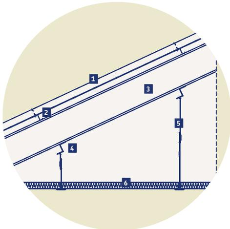
1. Cubierta chapa metálica 2. Correas metálicas 3. Estructura metálica 4. Grapa para fijación 5. Varilla roscada 6. URSA TERRA
