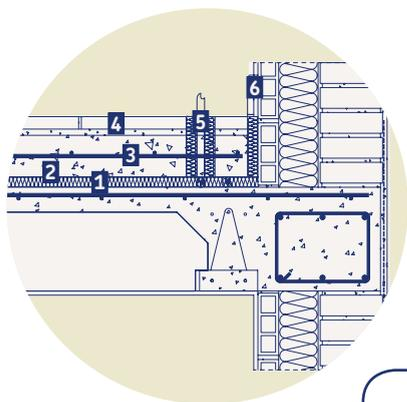
1. URSA TERRA Sol 2. Film de separación 3. Losa de hormigón armado 4. Pavimento 5. Instalaciones 6. Detalles desolidarización perimetral.
