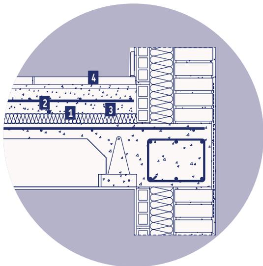
1. URSA XPS 2. Losa hormigón 3. Hilo radiante 4. Pavimento
