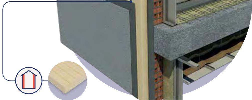
Eliminación del puente térmico. Con el sistema SATE se minimizan los puentes térmicos integrados en la fachada.
