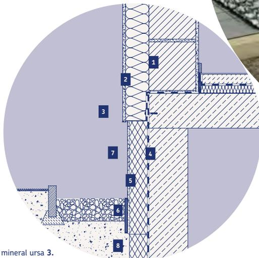
1. Pared exterior 2. Materiales aislantes de lana mineral ursa 3. Revestimientos de fachada 4. Sótano de pared exterior. 5. Sellado 6. URSA XPS N-VII L 7. Yeso de 7 bases. 8. URSA XPS N-III-L
