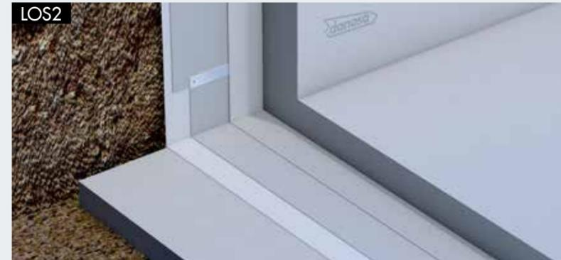
**Aplicación:** Protección a la humedad en spas, piscinas interiores, losas de cimentación.
