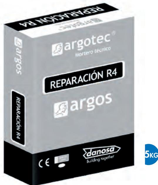
ARGOTEC REPARACIÓN FLUIDO R4 es un mortero polímero modificado (PCC) fluido, monocomponente, de altas resistencias y sin retracción para reparación estructural de pavimentos de hormigón, formulado a base de mezcla de conglomerantes hidráulicos, áridos seleccionados, polímeros y fibras que le proporcionan una excelente adherencia y propiedades mecánicas.
