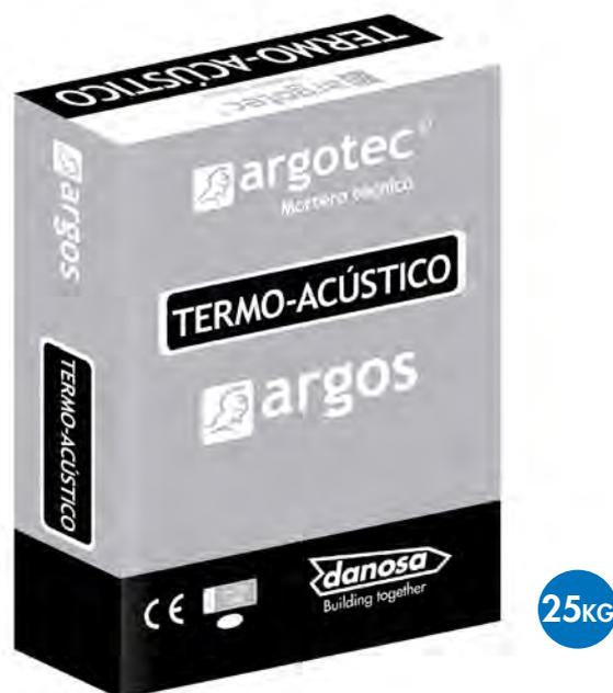
ARGOTEC TERMOACÚSTICO es un mortero adhesivo para colocación de lana mineral sobre el cerramiento, formulado a base de cemento portland, áridos seleccionados, polímeros y fibras que le proporcionan una excelente adherencia e impermeabilidad.
