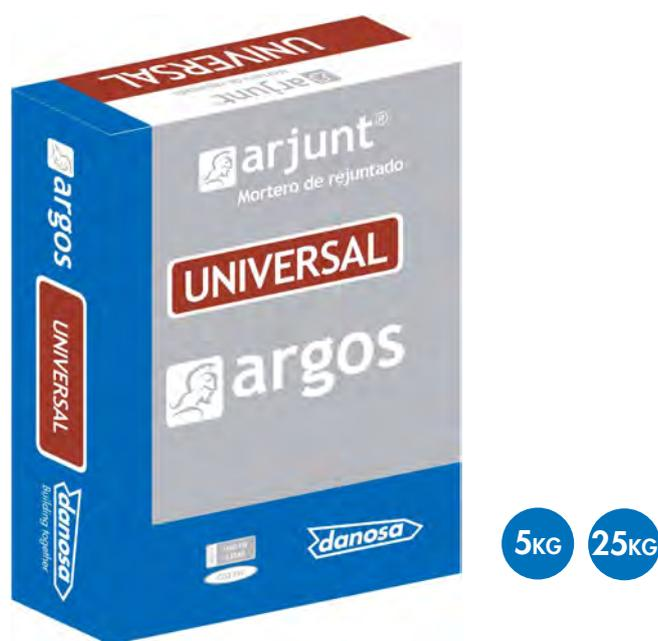
ARJUNT UNIVERSAL es un mortero polímero modificado coloreado a base de conglomerantes hidráulicos, resinas y aditivos además de incorporar un agente biocida de amplio espectro que le confiere al producto la capacidad alguicida y funguicida necesaria para su uso en contacto con agua y zonas húmedas.
