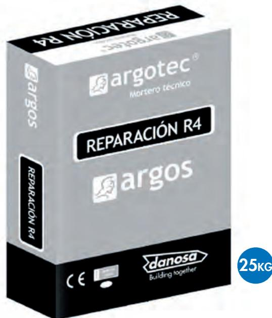
ARGOTEC REPARACIÓN R4 RÁPIDO es un mortero polímero modificado (PCC) tixotrópico, monocomponente, de fraguado rápido y sin retracción para reparación estructural de elementos de hormigón, formulado a base de mezcla de conglomerantes hidráulicos, áridos seleccionados, polímeros y fibras que le proporcionan una excelente adherencia y propiedades mecánicas.
