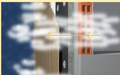
4. Ausencia de riesgos de condensación en la fachada (circulación de aire a lo largo de la cámara ventilada).
