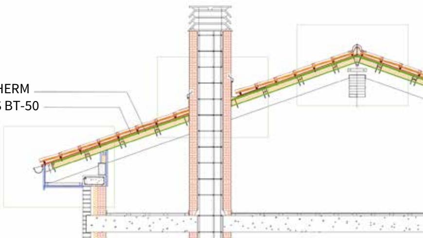
*Cubierta doble de teja cerámica mixta y placa resino-asfáltica en masa Onduline® Bajo Teja DRS BT-50 sobre panel sándwich ONDUTHERM.*
