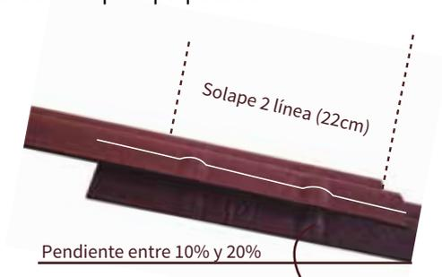
En la instalación sobre soportes discontinuos (no recomendada), asegurar que el solape quede siempre sobre el apoyo.
