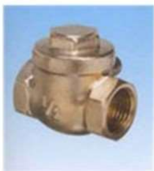
Figura 77: Ejemplo de válvula de retención, instaladas en impulsión de bombas y símbolo habitualmente utilizado
