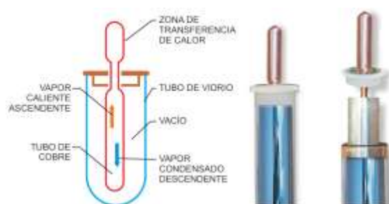
Figura 20: Captador de tubos de vacío con “tubo de calor” (heat-pipe)
