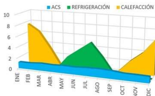
Figura 111: Ejemplo típico de la variación anual de las demandas de ACS, calefacción y refrigeración
