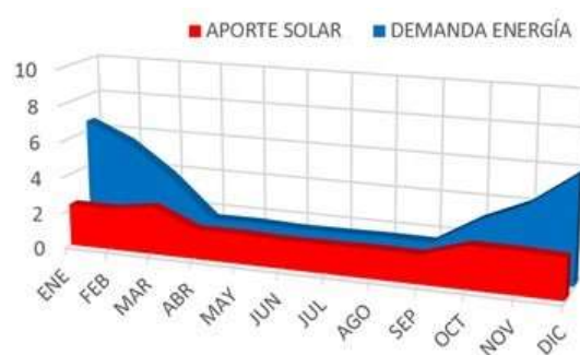
Figura 113: Variación anual de la demanda de energía y el aporte solar de baja contribución para ACS y calefacción
