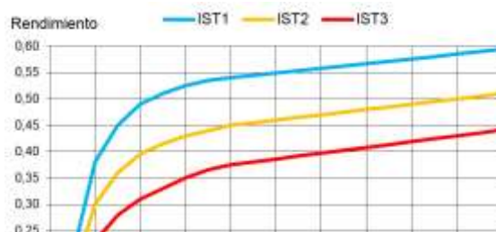
Figura 64: Variación del rendimiento de instalaciones con el volumen de acumulación
