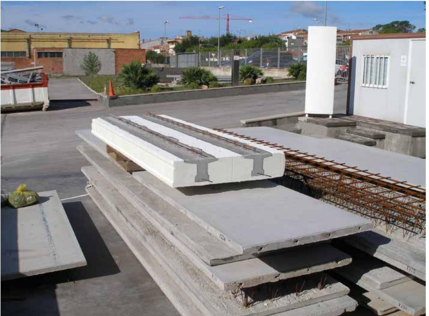
Estas piezas de EPS se colocan en bancadas en las que se instala la armadura metálica, se vierte el hormigón y tras el vibrado queda conformada la placa de forjado. Modultherm puede fabricarse en hormigón armado o pretensado.
