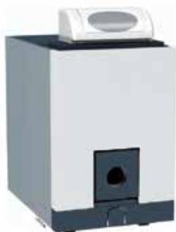
Cuerpo de caldera formado por elementos de fundición de alto intercambio de calor y gran caudal de agua. Hogar sobrepresionado de alta eficiencia y calorifugado con doble aislante de fibra de vidrio de 50 mm de espesor.
