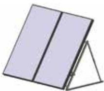
Soportes premontados para facilitar su instalación. Permiten variar la inclinación desde 35° a 55°. Para filas de más de dos colectores se deberán montar suplementos a partir del tercer colector. Por ejemplo, en una fila de 5 colectores se deberá montar un soporte para dos colectores y tres suplementos.
