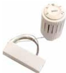
Cabezal termostático con sensor líquido a distancia, con sistema de enganche rápido Clip-Clap, con posiciones de regulación de frío a calor, que corresponden a un rango de temperaturas de 8 a 32 °C.
