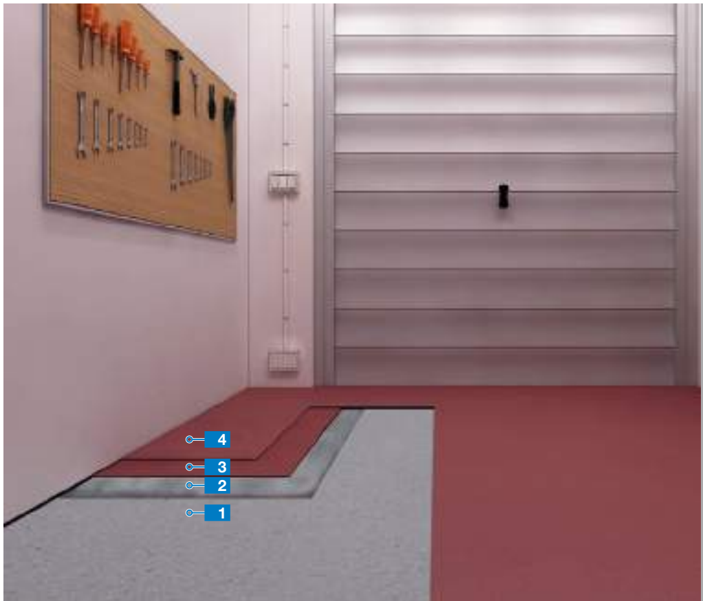
Sistema para pavimentos a base de resina epoxídica para aparcamientos subterráneos
