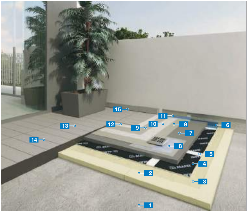
Impermeabilización y colocación de cerámica en terrazas con sistema de aislamiento acústico contra el ruido de impacto
