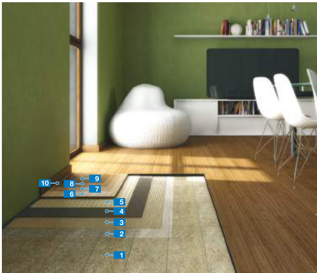
Sistema fonoaislante para la colocación de parquet sobre pavimento existente de baldosas hidráulicas
