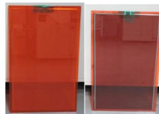
Figura 6. Ejemplo de prototipo vidrio-vidrio desarrollado: vista frontal (izquierda) y vista trasera (derecha) de prototipo con semitransparencia del 30% basado en tecnología de silicio amorfo y con color naranja: a-Si, 600 mm x 350 mm, 3.2 mm + 2 mm,
