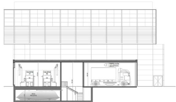
Figura 6. Sección sala de calderas biomasa.
