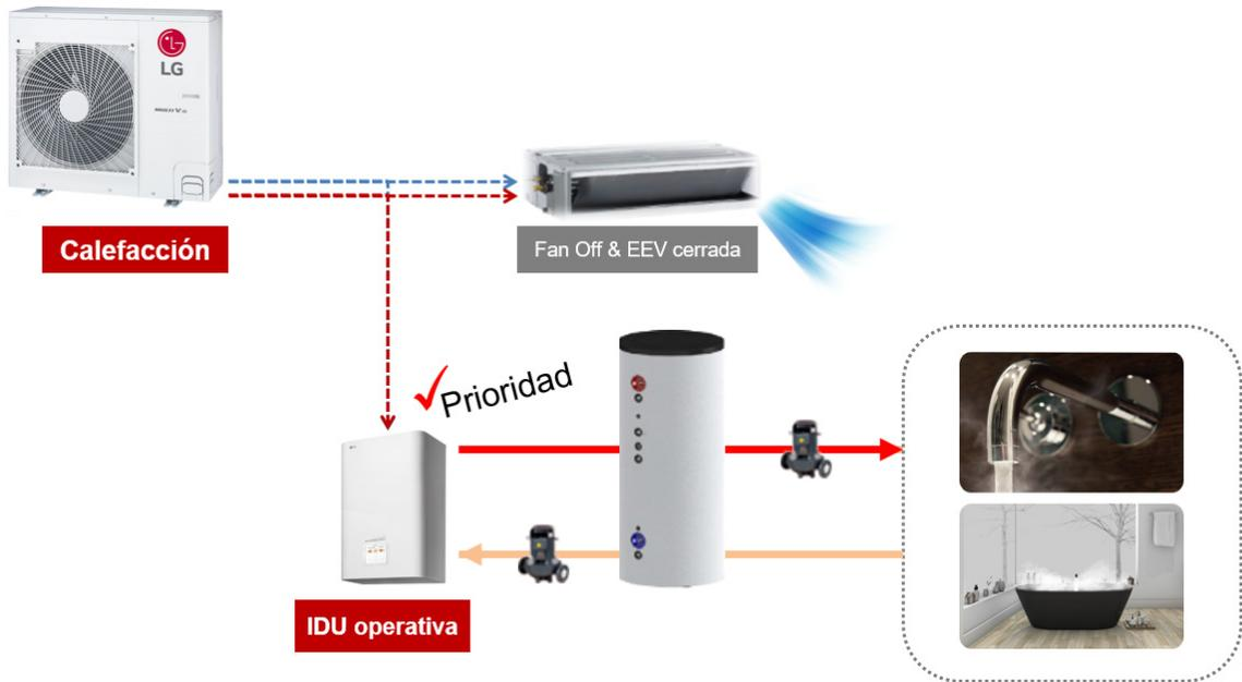
Figura 1. Sistema de Aerotermia Híbrida con R32.
