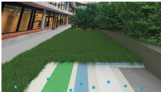
Figura 5. Esquema de solución constructiva de cubierta ajardinada. (Leyenda: 1 Soporte de impermeabilización; 2 Capa antipunzonante geotextil DANOFELT® PY 300; 3 Lámina impermeabilizante DANOPOL® FV 1.2; 4 Capa separadora geotextil
