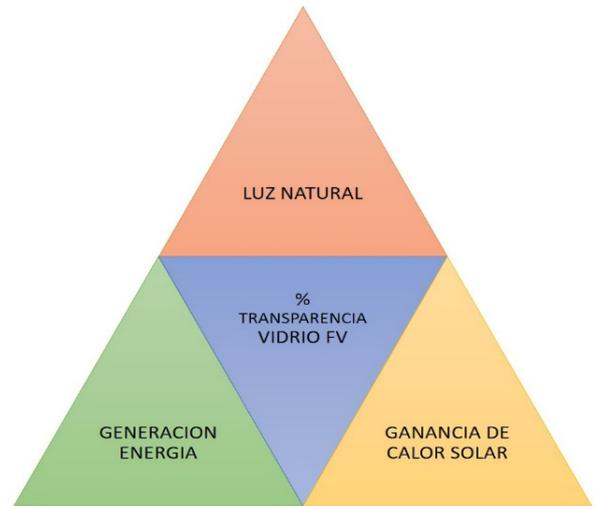
Figura 4. Matriz de variables afectadas por el grado de transparencia de los vidrios fotovoltaicos.
