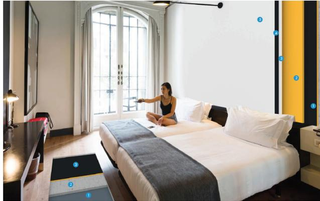
Figura 4. Esquema de soluciones constructivas para aislamiento acústico. (Leyenda en pared: 1 ACUSTIDAN®; 2 ROCDAN®; 3 Placa de yeso laminado; 4 DANOSA M.A.D.® 4; 5 Placa de yeso laminado. Leyenda en suelo: 1 Aislamiento acústico IMPACTODAN® 5; 2 Mortero autonivelante ARGONIV; 3 Aislamiento acústico FONODAN® 900).
