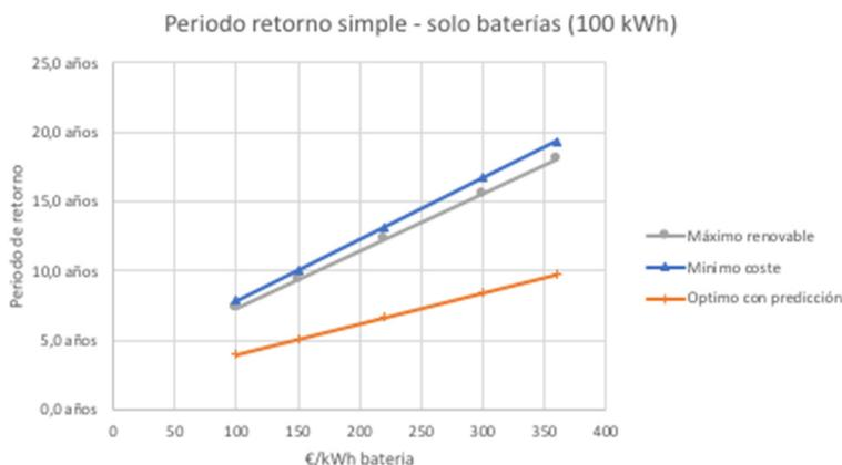
Figura 58. Estudio de sensibilidad de los algoritmos (periodo de retorno) en función del precio de las baterías.
