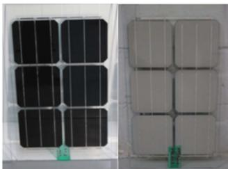
Figura 5. Ejemplo de prototipo vidrio-vidrio desarrollado: vista frontal (izquierda) y vista trasera (derecha) de prototipo semitransparente basado en tecnología de silicio cristalino: c-Si, 600 mm x 350 mm, 2 mm + 2 mm
