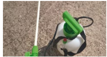
Antes de la aplicación del mortero de fraguado ultrarápido, humedecer el soporte con agua sin encharcar.
