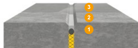
Sellado de juntas horizontales con tráfico.
