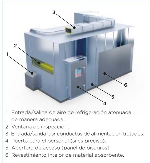
1. Entrada/salida de aire de refrigeración atenuada de manera adecuada.
