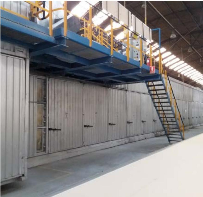
El Secadero, es parte de la línea de producción de la planta de Saint-Gobain Placo de Quinto en Zaragoza. La principal función del secadero consiste en retirar la humedad de las placas de yeso laminado mediante la incorporación de aire caliente y la extracción de aire húmedo, permitiendo que el material se vaya secando a lo largo de la línea por el interior de un túnel de longitud de 104 metros aproximadamente.
