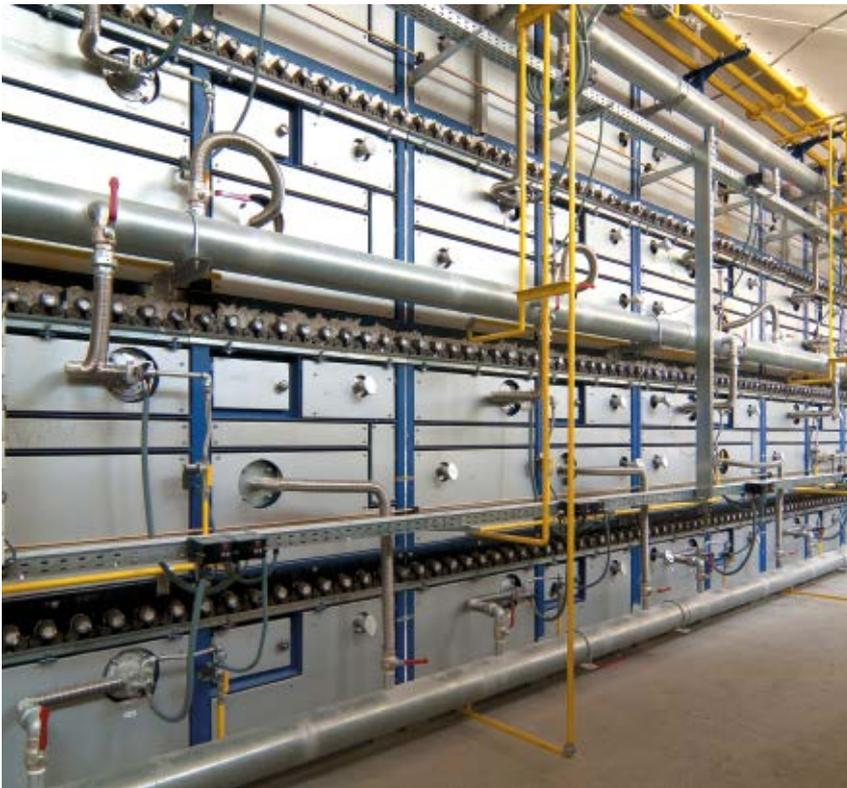
El horno cerámico es una unidad de producción flexible e innovadora en construcción modular prefabricada con revestimiento de ladrillos ligeros refractarios, y aislamiento térmico. Equipado con concepciones modernas de mando del horno y sistemas de seguimiento de vagonetas, el horno se usa para la primera cocción o cochura, la cochura de calor cerámica, la cochura bizcocho y la cochura de vidrio, dando un perfil de temperatura idóneo para el material cerámico.
