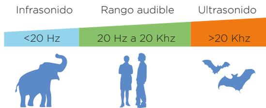
Por debajo del rango humano audible se encuentra el área de infrasonido. Como aplicación práctica, el infrasonido se utiliza como soporte para vibraciones, sonido transmitido por estructuras, análisis de vibraciones en edificios, ondas sísmicas, etc. Por encima del rango humano audible, tenemos los ultrasonidos.
