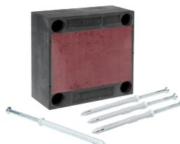
Cubo de espuma de poliuretano de alta densidad, que incorpora una placa de acero. Idóneo para el montaje de cargas de hasta 500 kg. Incluye los anclajes necesarios para su correcto montaje. No genera puentes térmicos.
