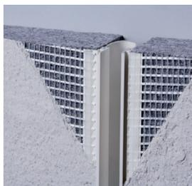
Perfil junta de dilatación con suplemento de PVC blando y malla de fibra de vidrio resistente a los álcalis. Indicado para ser instalado entre paneles aislantes en caso de juntas estructurales o puntos de sollicitaciones especiales de absorción de movimientos.
