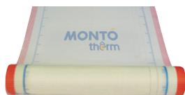
Malla de fibra de vidrio con tratamiento anti-álcalis, empleada como base de la capa de refuerzo del Sistema MONTÓ therm®. Certificada según la ETAG 004 para Sistemas de Aislamiento Térmico Exterior. El marcado en los bordes, define el solape mínimo y contribuye a una mejor colocación y nivelación de la malla.
