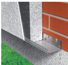
Perfil de arranque de aluminio para el replanteo inicial y apoyo de paneles aislantes del Sistema MONTÓ therm®.
