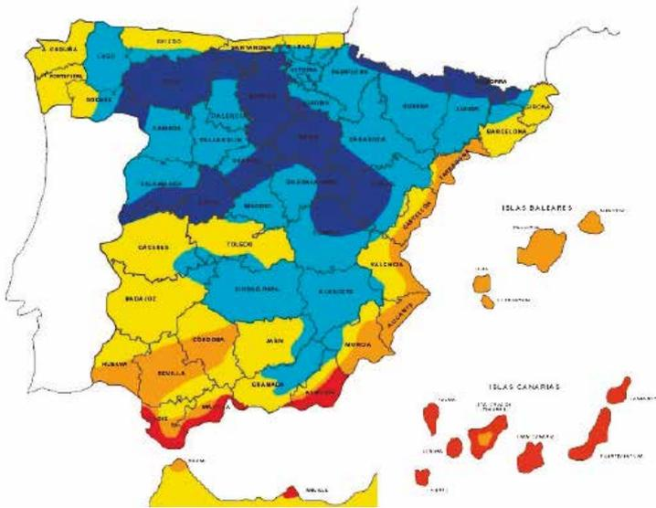
La tabla a-Anejo B del DB-HE permite obtener la zona climática (Z.C) de un emplazamiento, en función de su provincia y su altitud respecto al nivel del mar (h)
