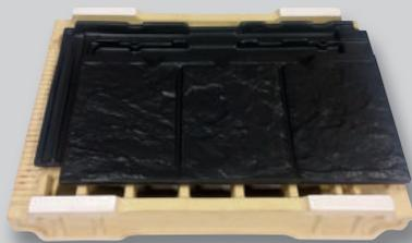
Soportes refractarios unitarios en H que permiten cocer las tejas de forma individual a alta temperatura, logrando una definición perfecta.
