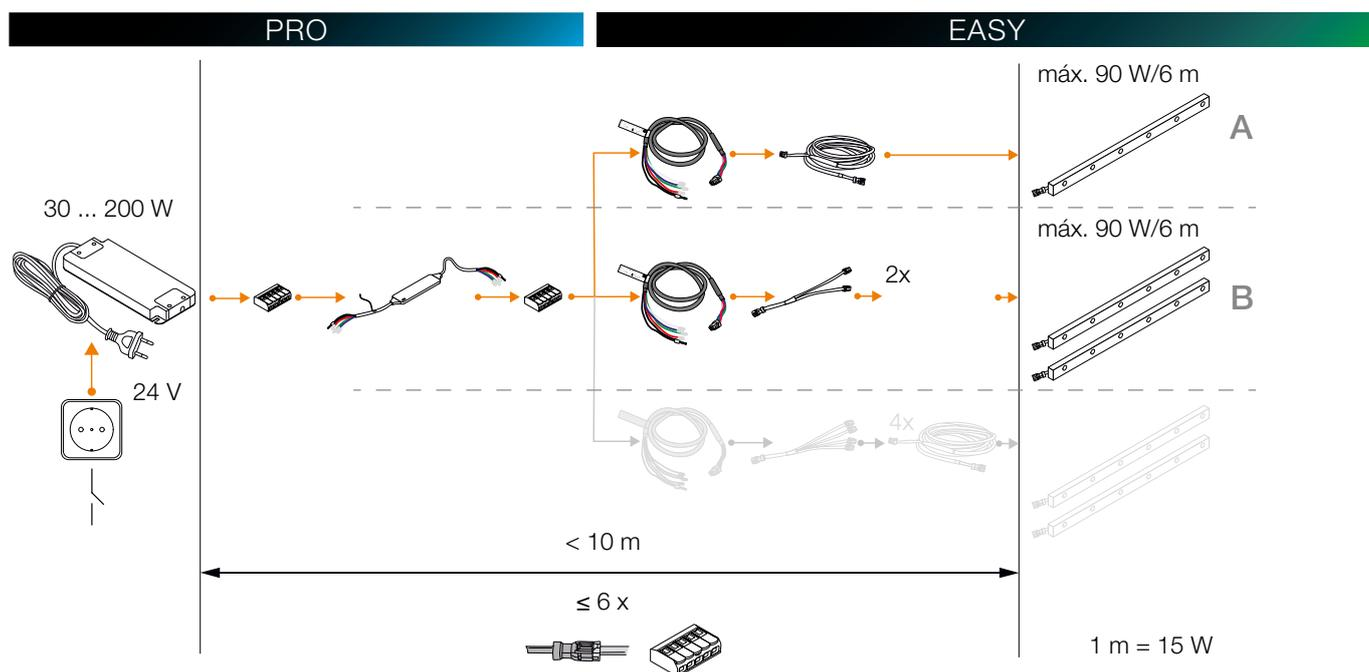
**Indicación:** Longitud máxima de los módulos LED conectados a través del sistema LIPROTEC-EASY cuando se usa el adaptador Plug & Play: 6 m por cada ramal de cables (A o B) dependiendo de la fuente de alimentación utilizada.
