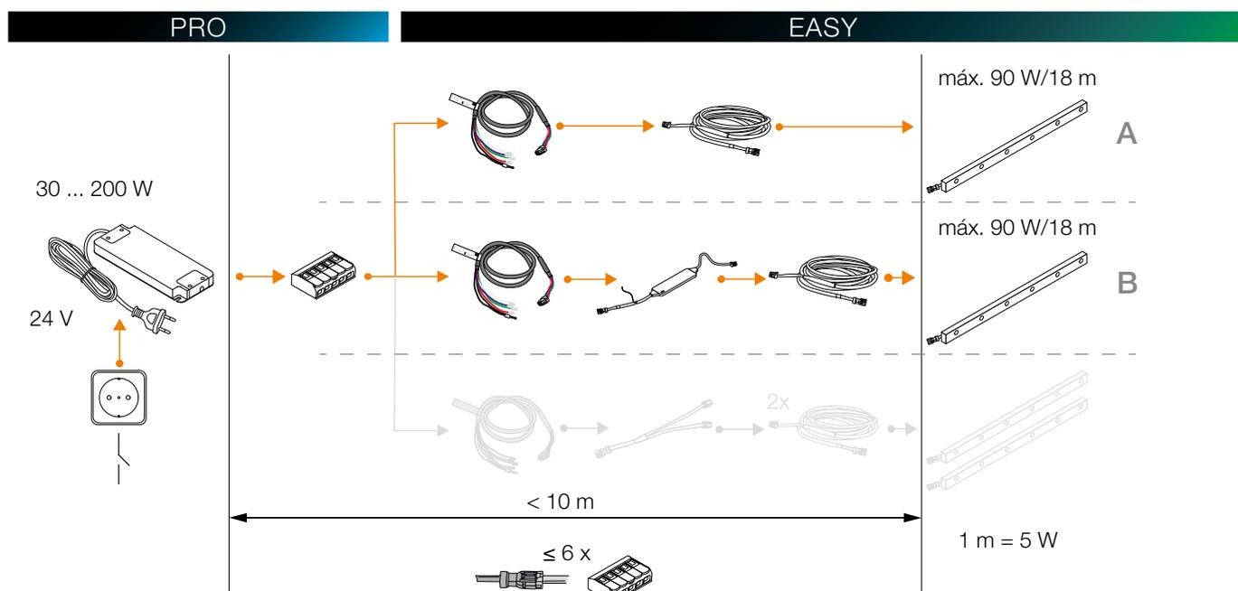
**Indicación:** Longitud máxima de los módulos LED conectados a través del sistema LIPROTEC-EASY cuando se usa el adaptador Plug & Play: 18 m por cada ramal de cables (A o B) dependiendo de la fuente de alimentación utilizada.
