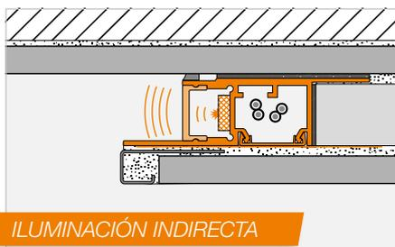
**Indicación:** El difusor de iluminación indirecta sólo se debe instalar en la ducha en vertical. El difusor para la iluminación directa no es apto para su instalación en zonas húmedas.
