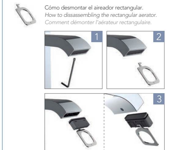
DESMONTAJE AIREADOR ENRASADO Aerator dismantling / Démontage aérateur caché
