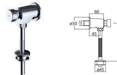
Grifo mural de 1/2" para urinario, 7 segundos, cartucho M28. Urinal 1/2", 7 seconds, cartridge M28. Robinet temporisé urinoir 1/2", 7 secondes, cartouche M28.
