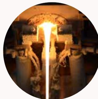
Horno de fusión donde toda la materia (arena de sílice, feldespato o dolomita y vidrio reciclado) se funde a altísimas temperaturas, superiores a 1.300 grados centígrados.
