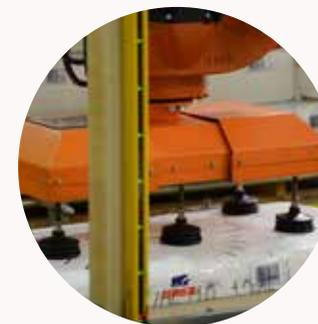
El material conseguido se ensaca y se paletiza de forma que se optimice el proceso, se gaste la menor energía posible y el material quede perfectamente protegido para su transporte o almacenaje.
