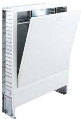
Schlüter-BEKOTEC-THERM-VSE es un armario empotrable en la pared que oculta el distribuidor de Schlüter y sus restantes componentes. El armario está fabricado en acero inoxidable galvanizado y dispone de estructuras de refuerzo para su estabilización, así como una serie de perforaciones en sus laterales en los que se insertan los tubos calefactores. La superficie (la puerta y los marcos) están lacados con pintura en polvo.
