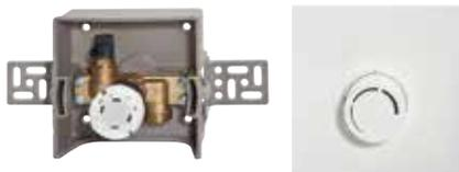
Schlüter-BEKOTEC-THERM-RTB es una válvula que limita la temperatura del circuito de retorno. Esta válvula se encastra en la pared y se instala en el extremo del circuito BEKOTEC. Se puede utilizar para limitar la temperatura del agua del circuito que estuviera instalado con anterioridad y también sirve para climatizar el suelo de una estancia con los radiadores existentes.
