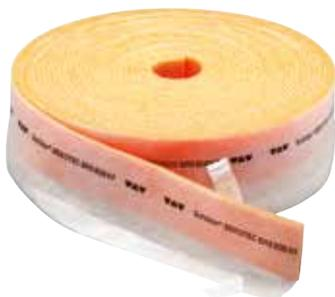
Schlüter-BEKOTEC-BRS/KF es una cinta perimetral de espuma de polietileno reticulada de celda cerrada con una tira autoadhesiva para su fijación tanto a la pared como al suelo. Con la colocación de la placa de nódulos BEKOTEC sobre el pie de apoyo se evita la filtración de mortero por debajo de las placas.
