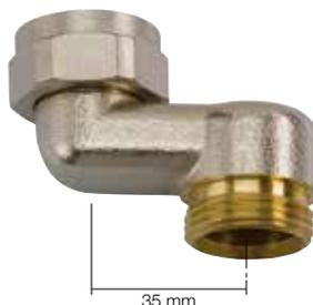
Schlüter-BEKOTEC-THERM-S35 es una pieza de empalme en forma de S de latón niquelado. Por un lado con una tuerca racor cónica de 3/4" (DN 20) y por otro lado con un racor de empalme cónico de 3/4" (DN 20) para la conexión de los tubos de calefacción con un diámetro de 10, 12, 14 ó 16 mm.
