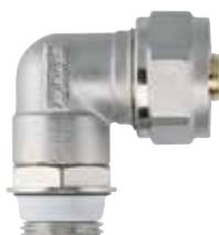
Schlüter-BEKOTEC-THERM-AW es un ángulo de empalme girable de latón niquelado. Por un lado con una rosca exterior estanca de 1/2" (DN 15) y por el otro lado con una rosca de apriete de 3/4" (DN 20) para el empalme al tubo de calefacción Schlüter de 14 ó 16 mm.
