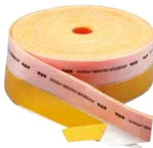
Schlüter-BEKOTEC-BRS/KSF es una cinta perimetral de espuma de polietileno reticulada de celda cerrada con una tira autoadhesiva para su fijación a la pared, al suelo y a la placa de nódulos. Con la colocación de la placa de nódulos BEKOTEC sobre el pie de apoyo se evita la filtración de mortero por debajo de las placas.
