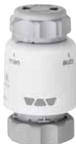
Schlüter-BEKOTEC-THERM-ESA es una electroválvula de 230 V, que se utiliza para controlar el flujo que pasa por la válvula de retorno. El montaje se realiza mediante tornillos (M30 x 1,5) a las válvulas del distribuidor de circuito de calefacción de retorno Schlüter, diseño según IP54 (protección contra salpicaduras de agua).
