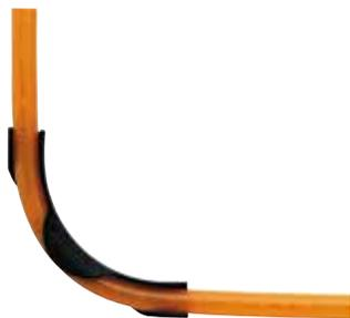
Schlüter-BEKOTEC-THERM-ZW es una curva de plástico, que se utiliza para definir un ángulo de 90° en los tubos calefactores de diámetro 10, 12, 14 y 16 mm que salen del armario de distribución al recrecido. Su colocación sobre el tubo calefactor es sencilla. Se recomienda su uso debido al espesor relativamente bajo del recrecido, facilitando así la instalación del armario de distribución.
