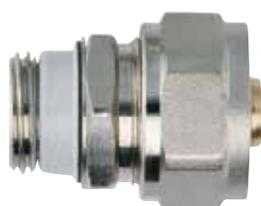
Schlüter-BEKOTEC-THERM-AN es una rosca de empalme de cobre niquelado. Por un lado con una rosca exterior estanca de 1/2" (DN 15) y por el otro lado con una rosca de apriete de 3/4" (DN 20) para el empalme al tubo de calefacción Schlüter de 14 ó 16 mm – apto para todos los accesorios Eurokonos.
