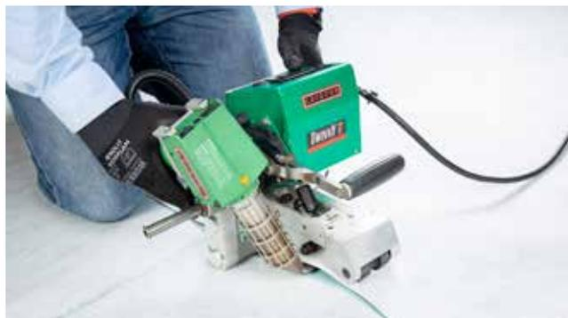
Unión mediante soldadura térmica
