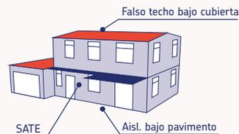
**3.b.** Rehabilitado con SATE en fachadas, falso techo bajo cubierta y aislamiento bajo pavimento en solera.
