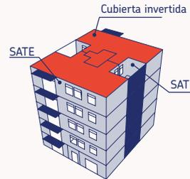
**1.c.** Rehabilitación con lana insuflada en fachada y patios y cubierta invertida
