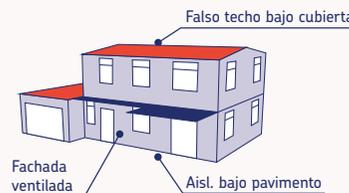
**3.c.** Rehabilitado con SATE en fachadas, falso techo bajo cubierta y aislamiento bajo pavimento en solera.
