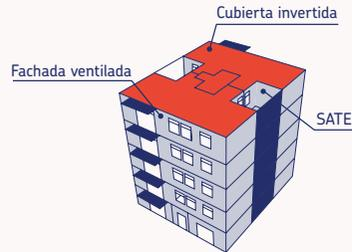
**1.b.** Rehabilitación con SATE en fachada y patios y cubierta invertida
