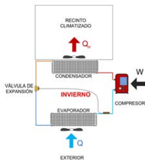
Esquema básico de sistema de climatización convencional en régimen invernal.
