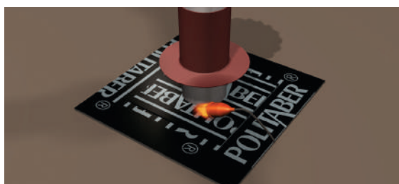
Aplicación del manguito. Adherido a la banda de refuerzo.
