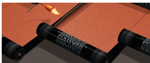
Alineación de los rollos. No coincidencia de solapes transversales.
