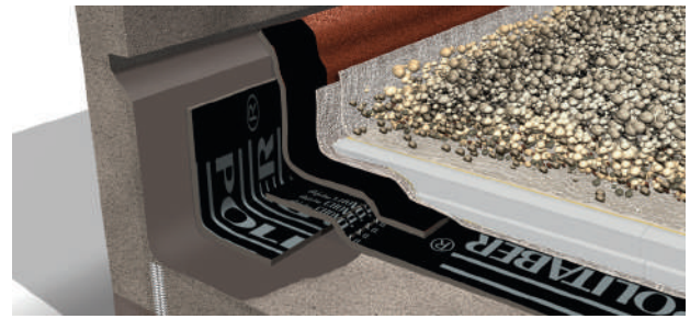
Cubierta invertida. No transitable, acabada con grava.
