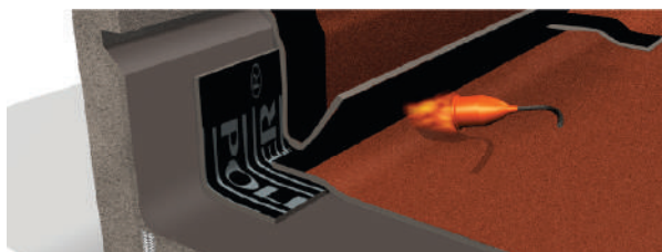
Aplicación de piezas de acabado.
