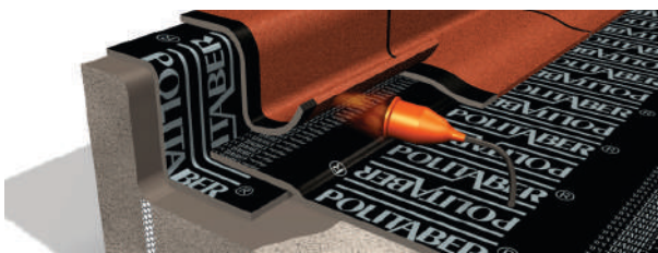
Rematar con lámina autoprotégida. Ejemplo monocapa.
