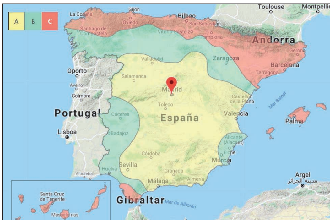
Figura 2.2: Diferentes zonas según la velocidad básica del viento
